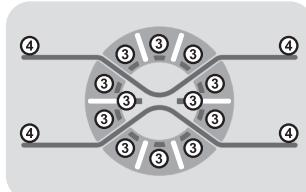
چراغ ایکس شکل با فشردن هر یک از کلیدهای صفحه لمسی روشن می گردد و با یک روشنایی پراکنده تا گوشه ها محو می گردد<sup>④</sup>.
